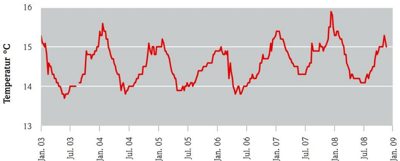
Jahreszeitliche Verschiebung der Temperatur des Grundwassers in 7 bis 9 m Tiefe; Messung 1 m unter Grundwasserspiegel. Grundwassermessstelle Wiesbaden-Biebrich Nr. 506034.
